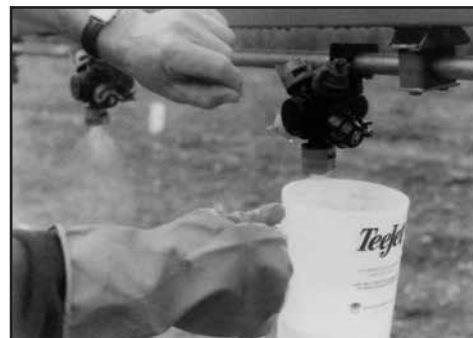
Test the actual output of the nozzles.
