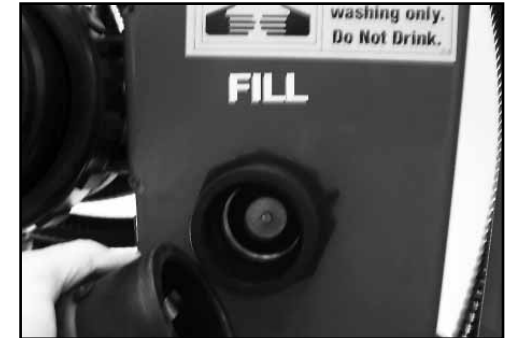
(1) Remove the cap of the Fill Inlet (3000 litre).
