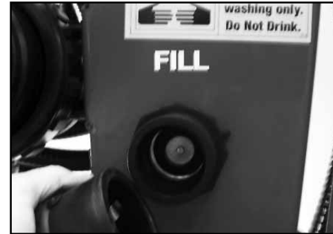
(1) Remove the end cap of the Fill Inlet (3000 litre).
