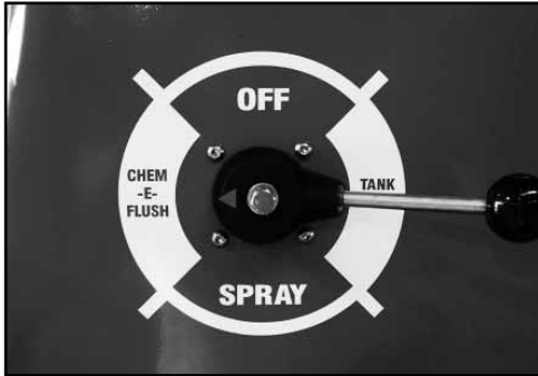
(d) Turn the Function Selector valve to "Chem-E-Flush".
