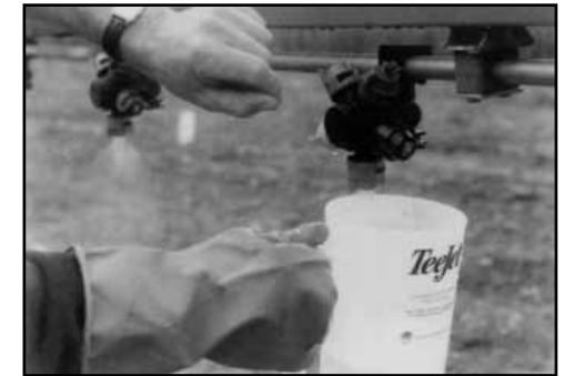
Test the actual output of the nozzles.
