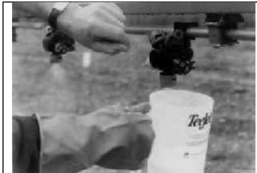
Test the actual output of the nozzles
