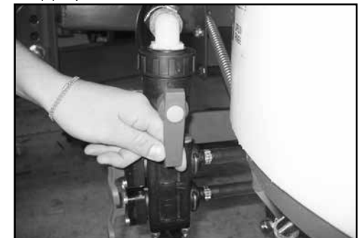
(d) Open Chem-E-Flush selector valve.
