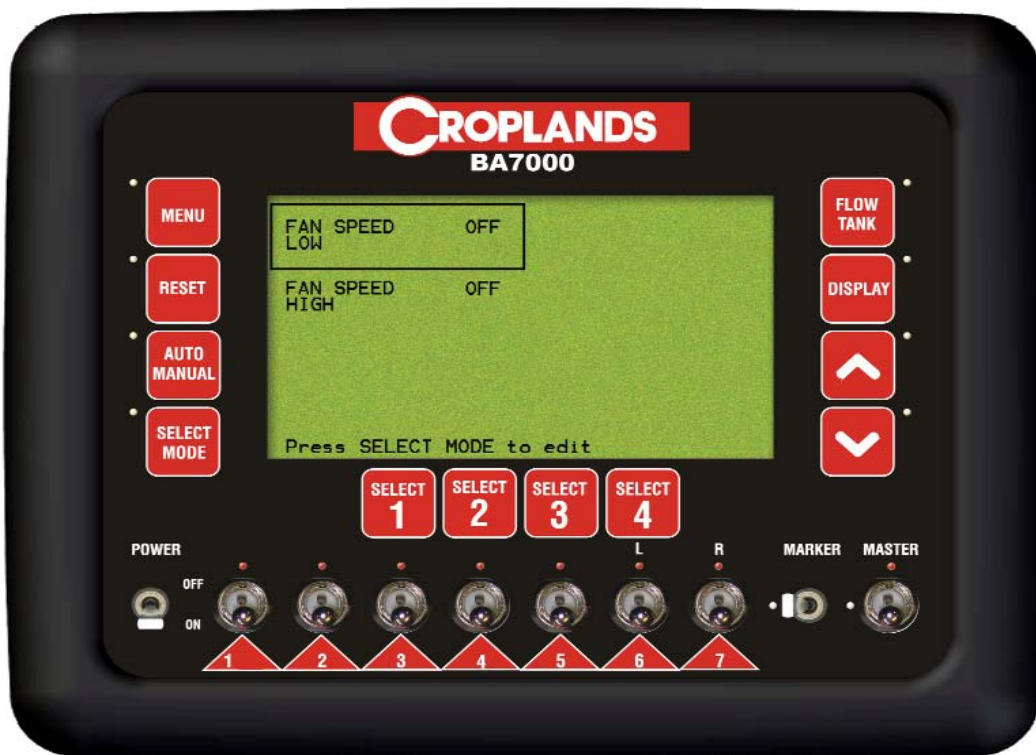
Fan Alarms Screen
