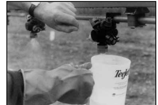
Test the actual output of the nozzles.
