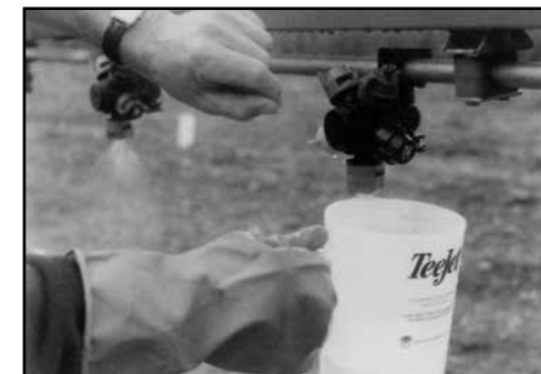
Test the actual output of the nozzles.
