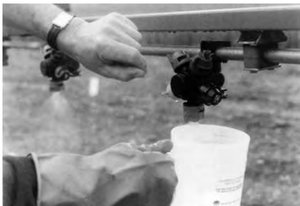
Test the actual output of the nozzles
