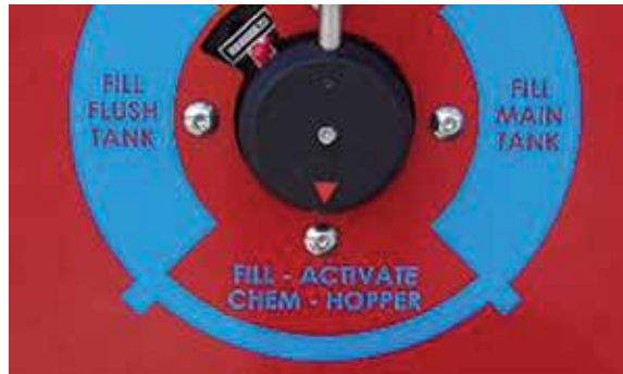
'Fill Valve' to 'FILL - ACTIVATE CHEM-HOPPER'
