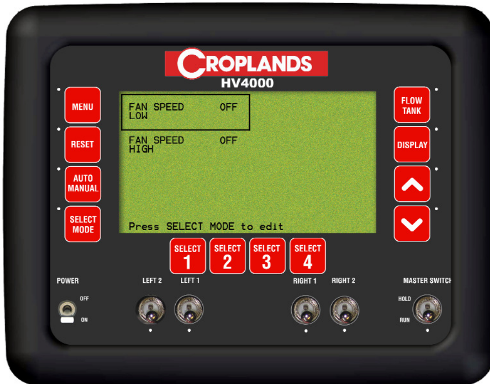
Fan Alarms Screen
