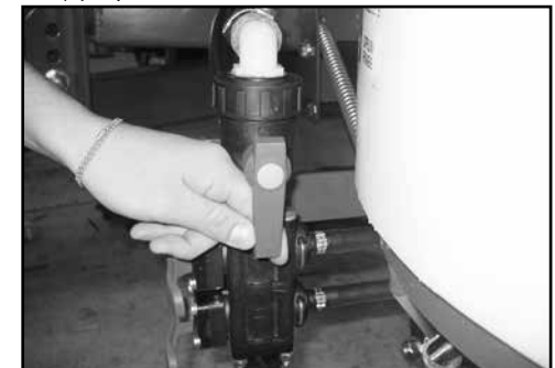
(d) Open Chem-E-Flush selector valve.
