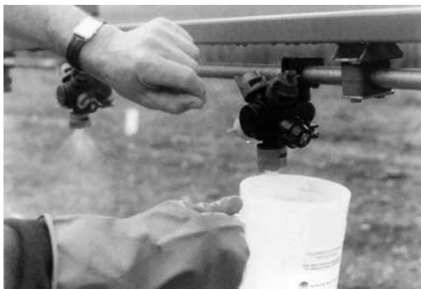
Test the actual output of the nozzles
