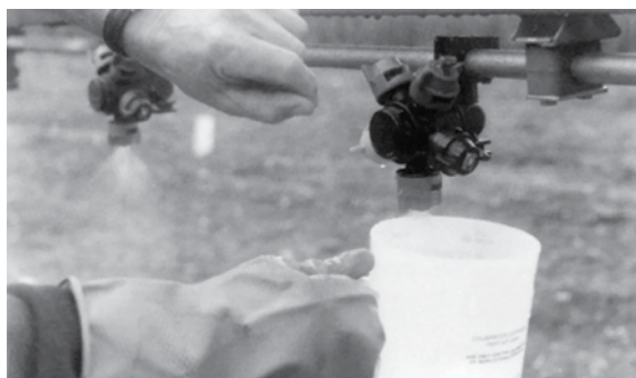
Test the actual output of the nozzles
